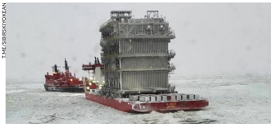
Un module de la nouvelle usine de gaz naturel liquéfié dont Total est partie prenante dans l'Arctique russe, en route depuis la Chine jusqu'à Mourmansk, début février 2022.
